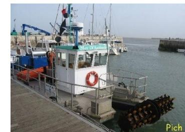
**- Bac à rateau**: le bac avance sous la poussée du courant généré par la décharge d'eau douce ou salée et par celui du courant de marée et remet en suspension les sédiments.
