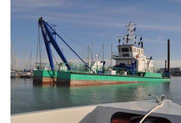
**- Rotodévaseur** : une fraise horizontale mécanique remet en suspension les sédiments qui sont transportés par les courants.
